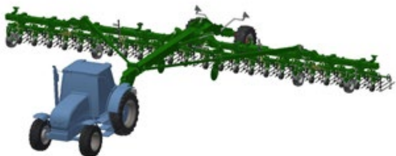
Tweezijdig enkelvoudig opklappend Twee scharnierpunten, maximale werkbreedte 9 meter.
