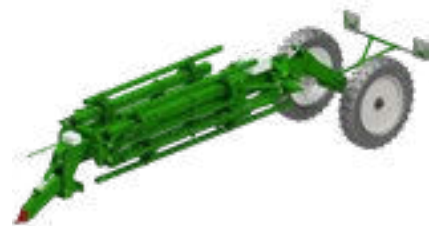
Half-gedragen Machine in de achterhef, half-gedragen met aankoppelbok, werkbreedten 12 - 27 meter.
