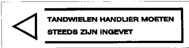
44 STICKER "TANDWIELEN HANDLIER MOETEN STEEDS ZIJN INGEVET"
