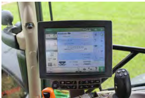
Bij snelheidsafhankelijke strooiers wordt het aftakstoerental direct op de terminal weergegeven.
