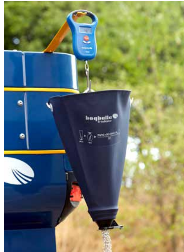
De S-indicator is eenvoudig te gebruiken en een volledige flowtest van een specifieke meststof wordt binnen enkele minuten uitgevoerd.
