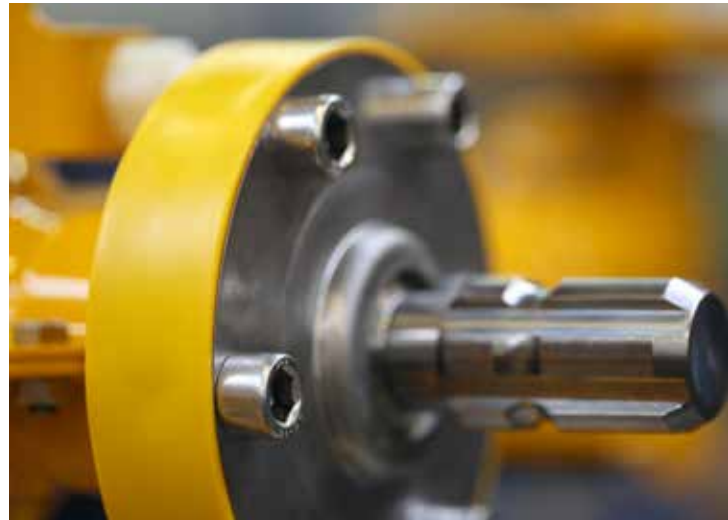
De geïntegreerde waterdichte en onderhoudsvrije overbelastingkoppeling beschermt de aandrijving van de machine bij het opstarten van de aftakas en bij een te hoog koppel.
