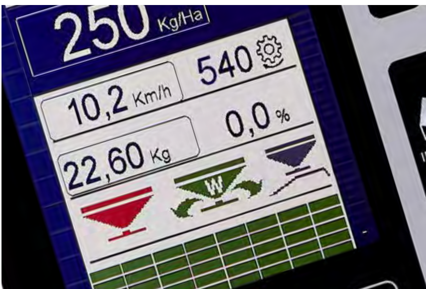
Strooiers met weegtechniek worden automatisch gekalibreerd, dus er is geen handmatige flowtest nodig.
